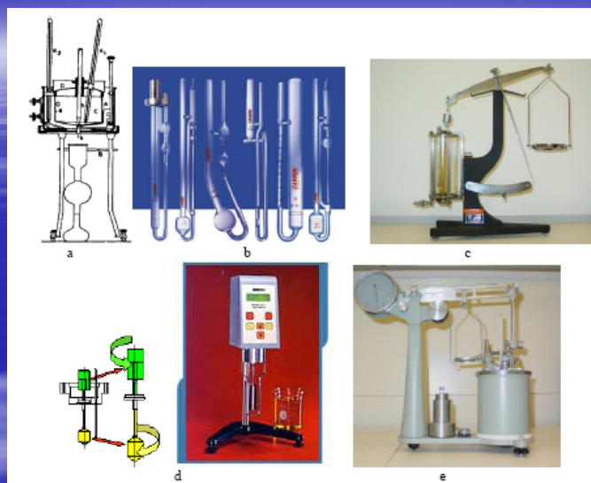
Razni tipovi viskozimetara (a – Englerov viskometar, b – kapilarni viskometri, c- maseni viskometar, d - torzioni viskometar(princip i foto), e – reometar)
